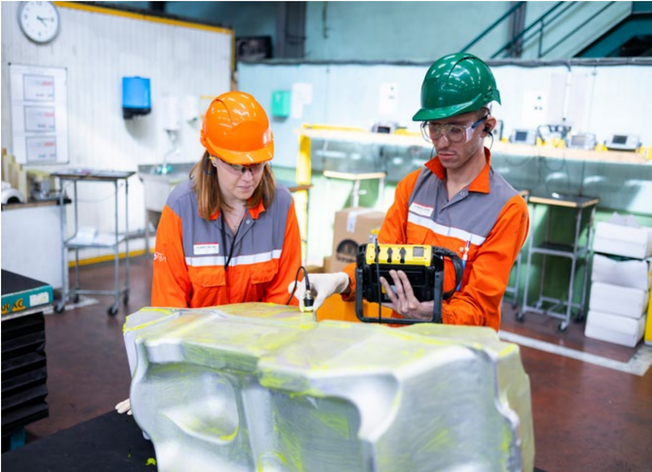
Contrôleur CND niveau 1 formant une contrôlease nouvellement arrivée sur une pièce aéro © Aubert & Duval/C.ABAD
