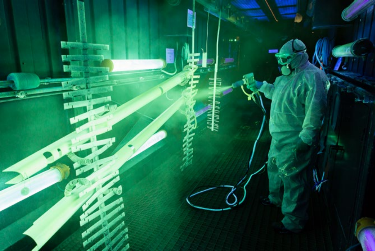
Dassault Aviation - Cabine de ressuage © Dassault Aviation/A.Février
